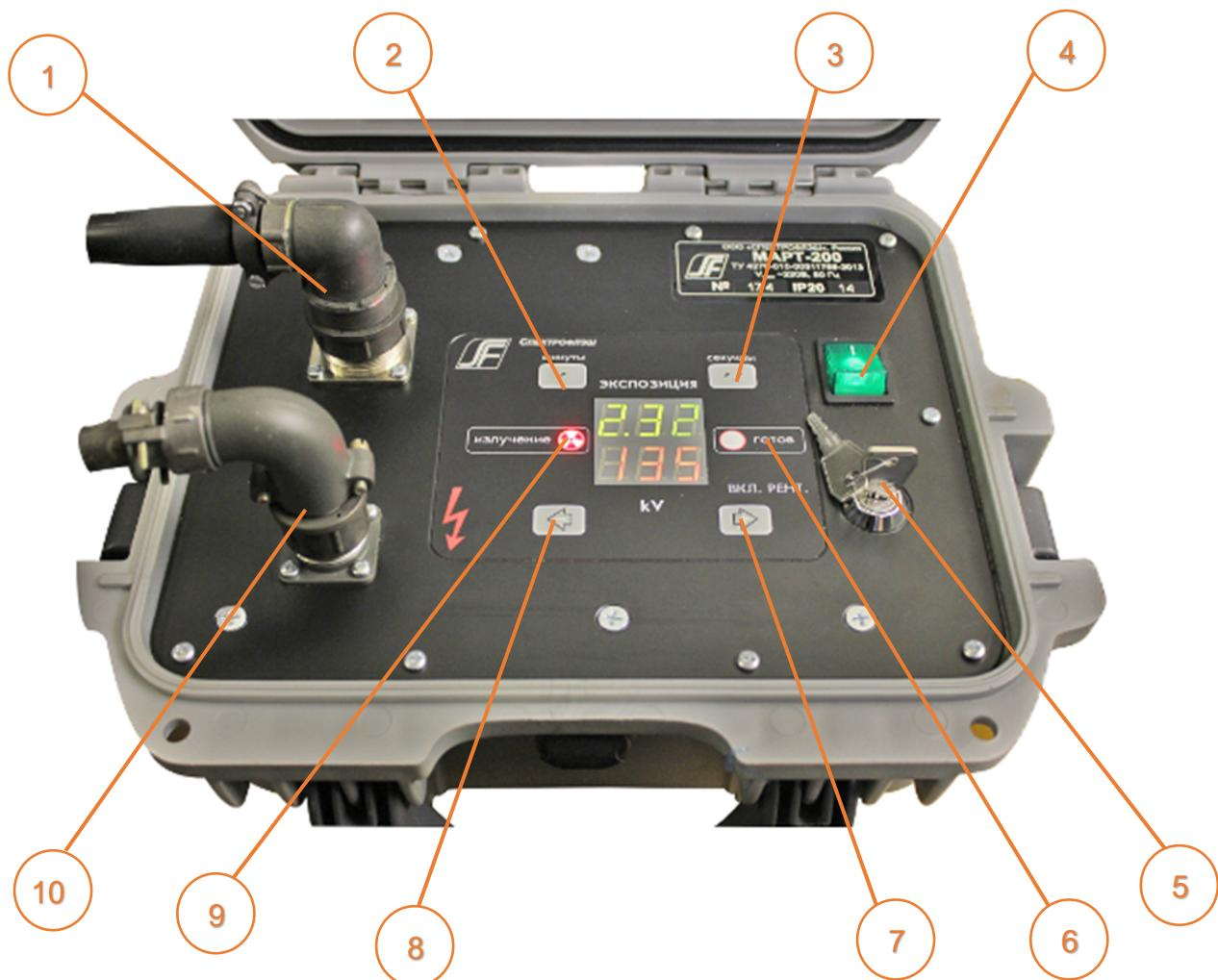
1 – Разъем для подключения высокочастотного кабеля, соединяющего пульт управления с рентгеновским блоком. В аппаратах «МАРТ-200» и «МАРТ-250» используются разъемы разных типов.
