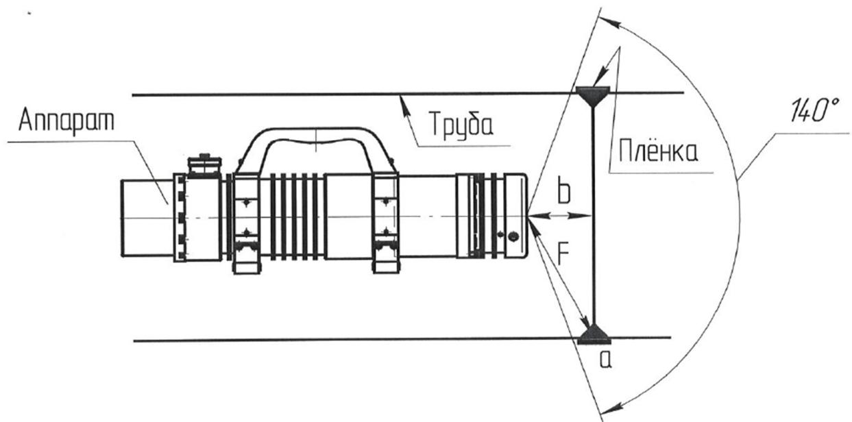
Рисунок 8 – Смещение аппарата «МАРТ-200» при панорамном просвечивании
